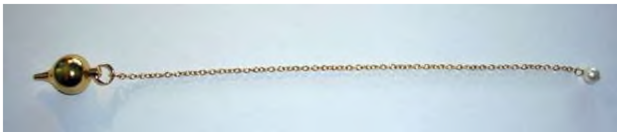
Fig. 1. Un pendule de 25 g avec une chaîne de 20 cm.
